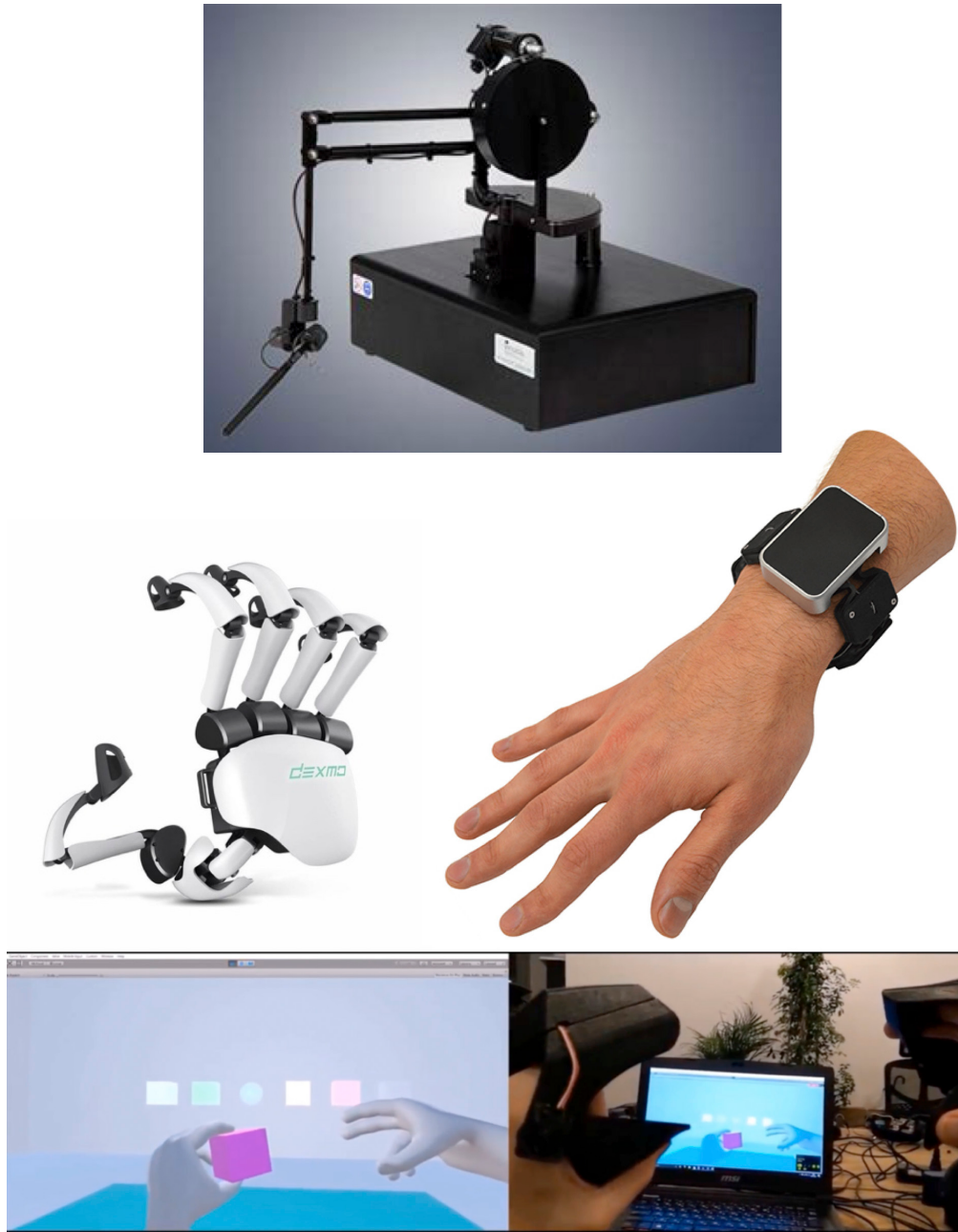
Figura 1. Algunos dispositivos de interacción háptica. 1) Dispositivo graspable Phantom Premium de 3DSystems 4 , evolución comercial actual del sistema de 1995 de Thomas Massie. 2) Guante Dextro de Dexta Robotics para VR 5 . 3) Prototipo de brazalete Tasbi de Facebook 6 , proporciona combinación de vibraciones y presión (ajuste dinámico de tensión) para imitar la realimentación háptica de los objetos virtuales. 4) Interacción con entorno virtual con EXOS Gripper de Exii 7 .
